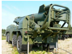
Detail startovacího stolu 9P117M1 a 2P19 (výše)
