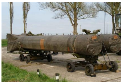
Skladový přepravník pro uložení RN a provádění prací „reglementu“ a skladových kontrol
