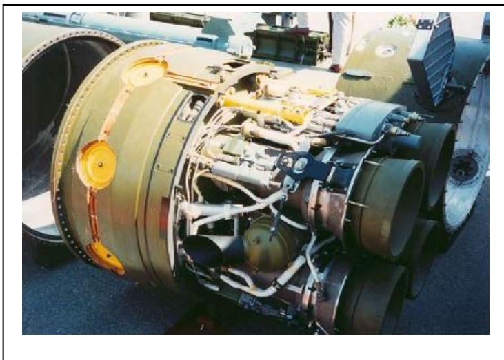
Řídicí systém trysek a kormidlových mechanismů
