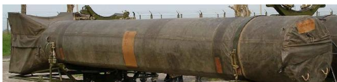
Všechny nosiče, byly udržovány (skladovány) v hermetickém obalu 9JA31.
