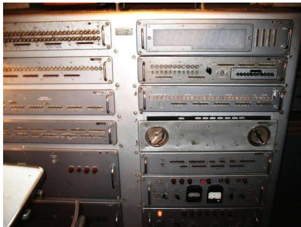
Počítač 9V51b v ZIL 131 PU – pro výpočet prvků
