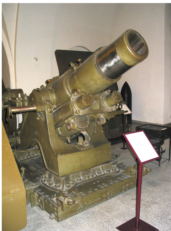
Moždíř 24cm vz.1898 - systém Škoda délka hlavně – 2180 mm, dostřel 6.500 m váha v pal.postavení –9.300 kg, obsluha 1+5 (muzeum – Arsenál ve Vídni)
