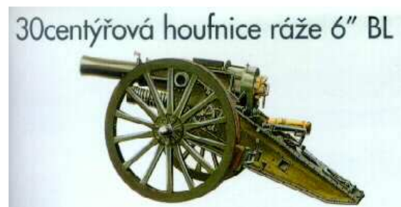
britská 152mm H vz.1896 , dostřel 4,7km šrapnel - 53,8 kg
