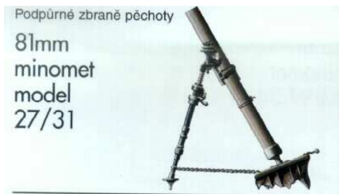
Francouzský 81 mm M vz. 27/3 dostřel 2.850 m / 1.200m, střela 3,25 kg / 6,5 kg standardní zbraň armád USA, Itálie, Sov.svazu, Jugoslávie (konstruktér – Edgar Brandt)
