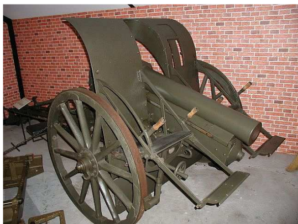
10cm polní H vz. 1910 soustava Škoda, dostřel 7.100 m, hmotnost 1.180 kg, střela 16 kg, poč.rychlost střely 350 m/sec zkušební dělo s předkluzem hlavně – vývoj zastaven pro hrubé závady
