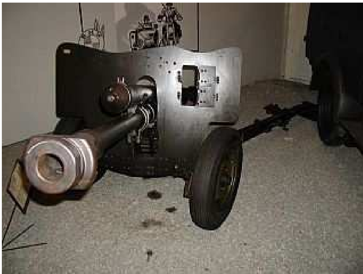
4,7 cm KPÚV vz. 38 A5 soustavy Škoda-Reichswerke-Herman Göring A.G. dostřel 4.000 m, hmotnost 570 kg, střela 1,65 kg, poč. rychlost střely 775 m/s,
