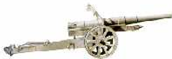
německý 135 mm K vz. 1909 dostřel 16.500 m, střela tříštivotrhavá 31,7 kg
