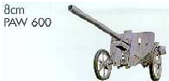
81,4 mm PTK PAW 600 (Pazerabwehrwerfer) účinný dostřel 750 m,, střela kumulativní 2,7 kg, pracující na novém balistickém principu (tzv. systém vysokého a nízkého tlaku)
