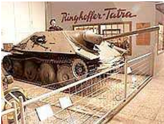
Německý Hetzer = Jagdpanzer 38 na podvozku čs. LT-38 (v r.1944 – 1945 také s 15 cm sIG, hmotnost 16.500 kg),
