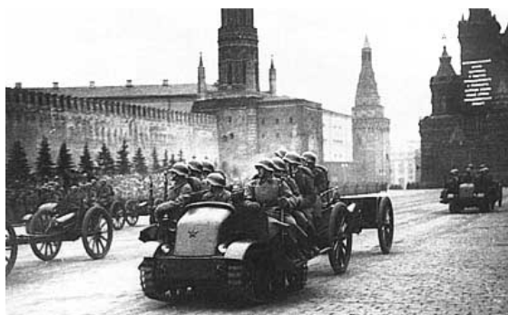
tahač „PIONÝR“ z r. 1935 se 76 mm K vz. 27 tahač „KOMSOMOLEC“ z r. 1936 se 45 mm PTK
