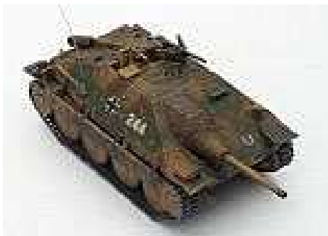
německý lehký stiháč tanků SdKfz 138/2 - „Jagdpanzer 38 - Hetzer“ se 75 mm PaK 39L/48 vyráběn od dubna 1944 do r. 1945 (2.584 ks), hmotnost 15.750 kg, obsluha 4 osoby, dojezd 170 km
