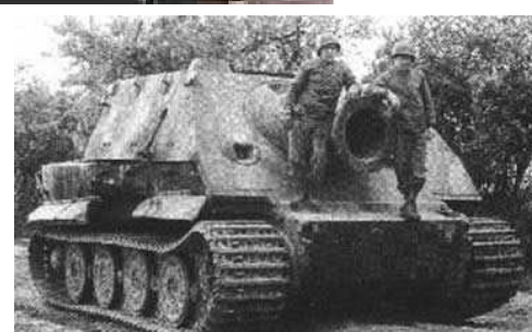
Německý Sturmtiger s 380 mm StuH RW61 L/5,4 hmotnost 65.000 kg, výroba v r. 1944
