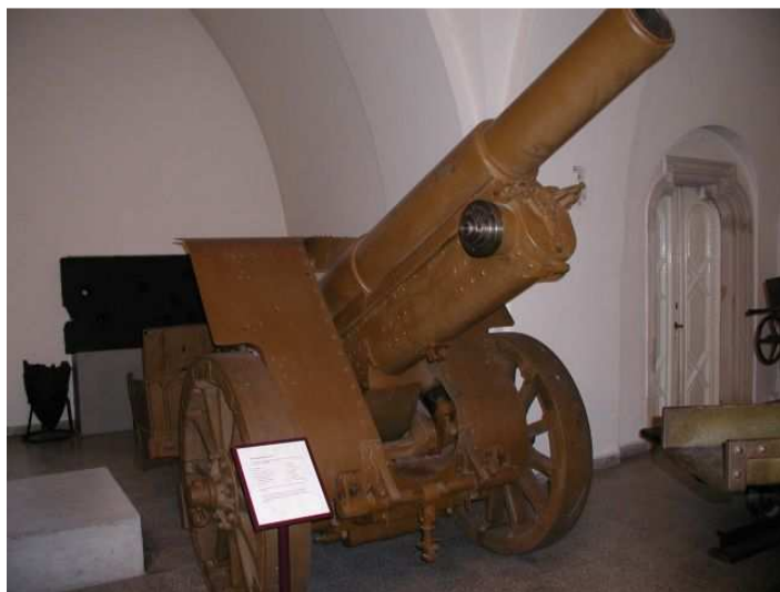
15 cm houfnice vz. 1915, systém Škoda dostřel 9.800 m, hmotnost 5.560 kg, střela 42 kg, poč.rychlost 500 m/s, obsluha 1+8 (v katalogu VHÚ 15 cm těžká H vz. 15 – dostřel 11.500 m, hmotnost 5.300 kg., později převzata do výzbroje čs.armády)
