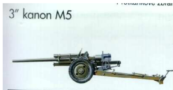
76,2 mm PTK M5 – z r. 1944? účinný dostřel 14.630 m, střela průbojná trhavá 6,98 kg, probíjí pancíř 100 mm na 1.000 m, při kolmém dopadu, využití po vylodění v Evropě a též jako výzbroj stíhače tanků M10
