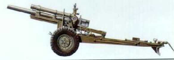
105 mm H M2A1 – výroba od r. 1941 dostřel 11.200 m, střela trhavá-14,97 kg, dělené střelivo, vodorovný klínový závěr, standardní zbraň divizního dělostřelectva USA (po válce jako M101 v armádách asi 67 států) vývoj v r.1920, zdokonalení v r.1930
