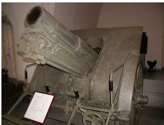
15 cm polní houfnice vz. 1914, systém Škoda, dostřel 8.000 m, hmotnost 2.765 kg (2.930 ?), střela 42 kg, poč. rychlost 340 m/s, obsluha 1+10 (též uvedeno - dostřel 9.700 m, střela 41 kg), ve výzbroji po válce (Rakouska, ČSR, Maďarska, Itálie)
