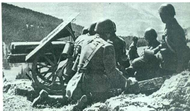
7,5 cm horský kanón vz. 15 , dostřel 7.000 m počáteční rychlost střely 350 m/s, hmotnost 620 kg, střela 6,5 kg, patřil k světově nejproslulejším výrobkům Škodovky – ve výzbroji řady cizích armád (převzat do čs. výzbroje - hlavní zbraň čs. horských baterií v r. 1938)
