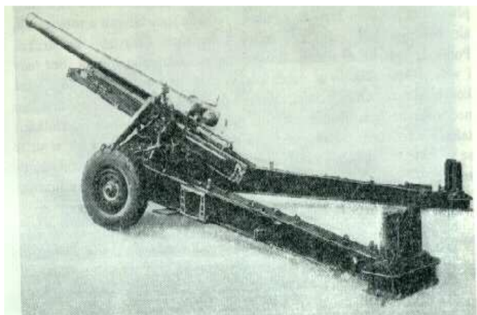
15 cm hrubá H vz. 37, dostřel 15.100 m, střela 42 kg, moto, bojová hmotnost 5.200 kg, dopravní 5.730 kg
