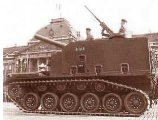
USA – 155 mm M44 dostřel 15.000 m, hmotnost 28.400 kg, 2 - 3 výstřely/min
