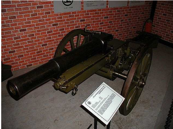
zkušební 7,5 cm horský K vz. 1910 s předkluzem hlavně soustava Škoda, dostřel 4.970 m, hmotnost 451 kg, střela 6,5 kg, poč.rychlost střely 340 m/s, pro řadu hrubých závad byly zkoušky zastaveny a tento způsob brždění zpětného rázu nepoužíván
