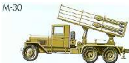
300 mm RM BM-31-12 („Váňuša“) dostřel 2.800 m, hlavice tříštivotrhavá, hmotnost rakety 72 kg na nákladním automobilu Studebaker
