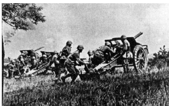
10 cm H vz. 30, dostřel 10.600 m, střela 16 kg, boj. hmotnost 1.766 kg, dopravní 3.077 kg, hipo počáteční rychlost střely 430 m/s, v r. 1938 158 ks
