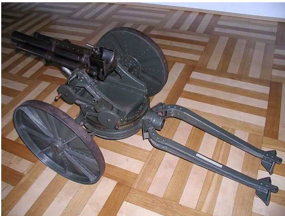
prototyp 7 cm pěchotního děla vz. 28, soustavy Škoda – nezavedený do výzbroje čs. armády (pokud se jedná o stejné dělo, pak katalog VHÚ pro 7 cm pěchotní dělo vz. 28 „BA“ uvádí - dostřel 2.500 m, hmotnost 126 kg, střela 3 kg, poč. rychlost 190 m/s, pro export do Litvy)
