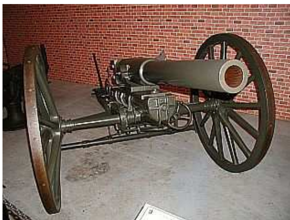
7,7 cm polní K d/27 z r. 1897 soustava Škoda, dostřel 6.500 m, střela 6,5 kg hmotnost 990 kg, poč.rychlost 600 m/s, poprvé sklopná rydla, pro tovární zkoušky
