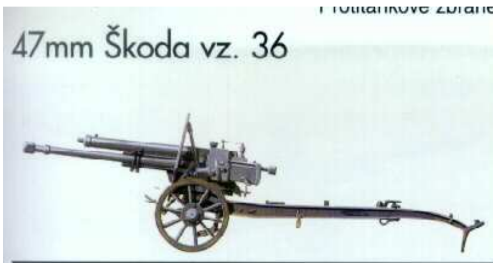
4 cm KPÚV vz. 36 (? – obdobně vypadá 4,7 cm KPÚV vz. 38 „A5“) účinný dostřel 4000 m, střela průbojná nebo trhavá 1,65 kg, průbojnost pancíře 60 mm na dálku 1.200 m, při 90° úhlu dopadu, pro přepravu se hlaveň otočila dozadu a zadní díl ramene se sklopil (od r. 1939 ve výzbroji okupační německé armády)
