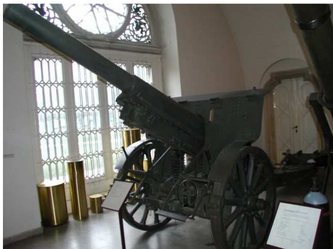
10,4 cm kanón vz. 1915, systém Škoda hmotnost 3.020 kg, střela 17,5 kg, dostřel 13.000 m, poč. rychlost 680 m/s, obsluha 1+9
