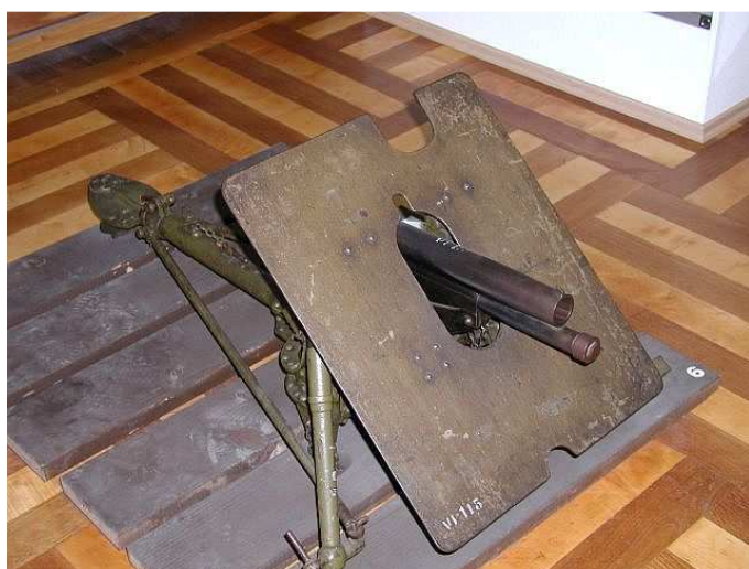
3,7 cm zákopové dělo (kanón ?) vz. 15, systém Škoda, dostřel 2.200 m, hmotnost 118 kg, střela 0,65 kg, počáteční rychlost střely 175 m/s
