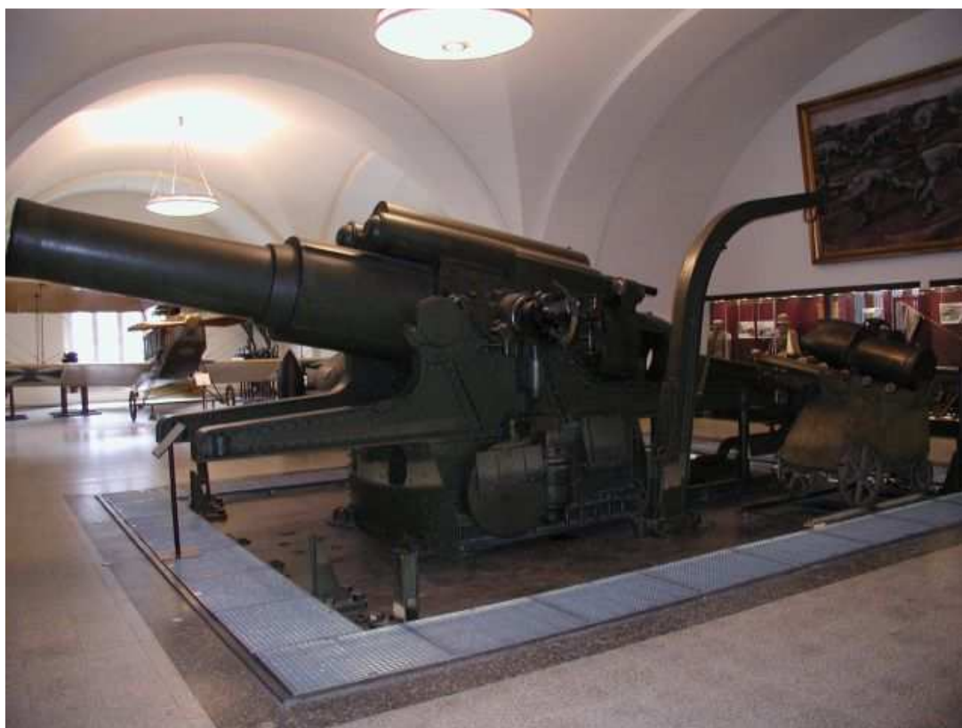
38 cm houfnice vz. 1916 s muničním vozíkem, systém Škoda dostřel 15.000 m, hmotnost v palebném postavení 81.700 kg, střela 740 kg, obsluha 1+11, 2 r/min
