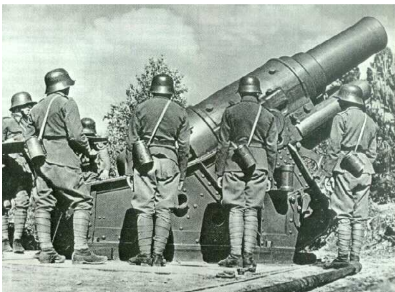
30,5 cm moždíř vz. 16, dostřel 3.500 -12.300 m, střela 380 kg (těžká) 289 kg (lehká), hmotnost děla v bojové poloze 23.000 kg odměř 360 stupňů (převzat do čs. výzbroje)
