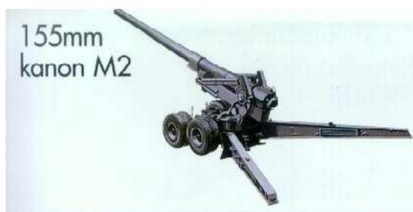
155 mm kanón M2 „Long Tom“ (Dlouhý Tom) dostřel 23 km (17km?), střela tříštvotrhavá 43 kg (v 30. letech modernizovaný franc. kanón z r.1917, jeden z nejlepších kanónů 2. svět. války)
