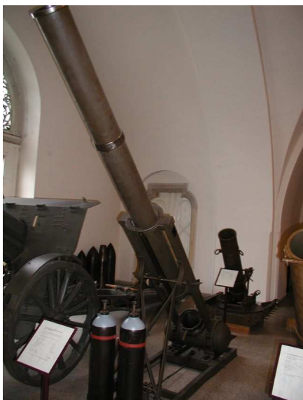
20 cm vzduchový minomet (204,8 mm Luftminenwerfer) systém Spitz-Bartelmus dostřel 1.150 m, hmotnost 725 kg, obsluha 1+4
