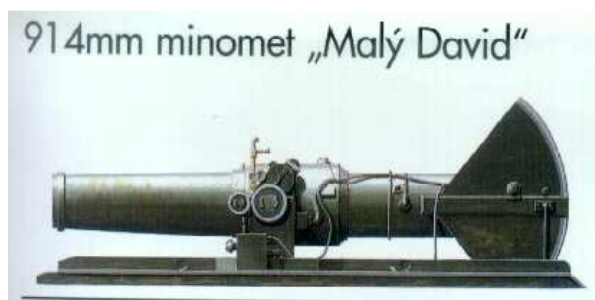
914 mm M „Little David“ (36 palcový moždíř) dostřel 8.700 m, střela trhavá 1.678 kg, prototyp obléhací zbraně pro úder na pevnosti na japonských ostrovech, než mohla být zdokonalena pro běžné použití válka skončila
