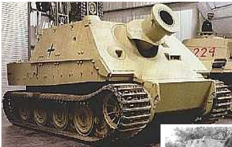
Německý Sturmtiger s 380 mm StuH RW61 L/5,4 hmotnost 65.000 kg, výroba v r. 1944
