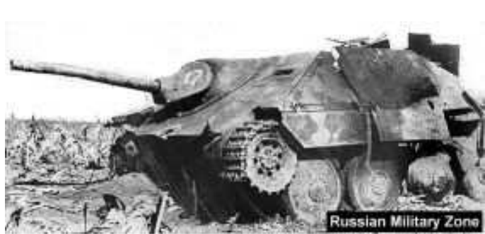
německý lehký stiháč tanků SdKfz 138/2 - „Jagdpanzer 38 - Hetzer“ se 75 mm PaK 39L/48 vyráběn od dubna 1944 do r. 1945 (2.584 ks), hmotnost 15.750 kg, obsluha 4 osoby, dojezd 170 km
