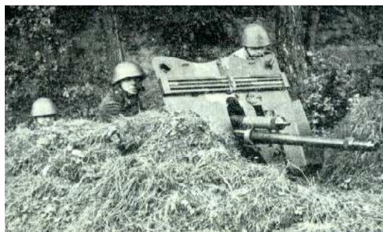
3,7 cm PTK vz. 37 M, dostřel 5.000 m, boj. hmotnost 370 kg, střela 0,85 kg, 750 m/s hipo i moto – v r. 1938 po 1.200 ks
