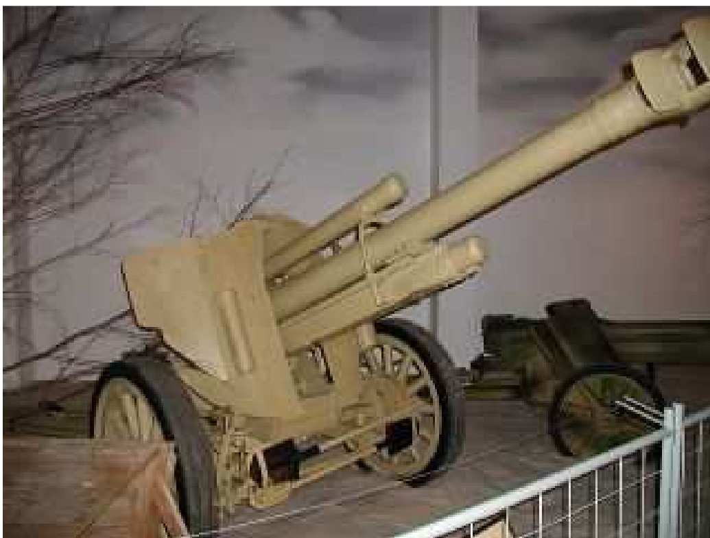
10,5 cm leFH 18/40, výrobci Rheinmetall-Borsig dostřel 12.325 m, hmotnost 1.900 kg, střela 14,8 kg, 6 - 8 ran/min, poč. rychlost střely 540 m/s
