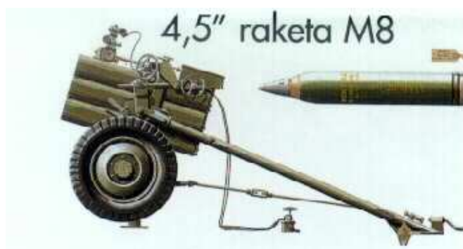
USA - 114 mm RM - raketa M8 dostřel 4.200 m, střela tříštvotrhavá 1,95 kg, nejrozšířenější americká raketa 2. světové války
