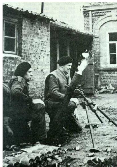
3 palcový minomet Mk I dostřel 1.400 m, hmot. 58 kg, stř. 4,5kg
