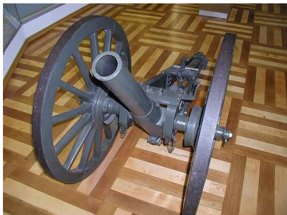
japonský 7,5 cm horský kanón vz. 98 soustavy Schneider, výroba zbrojovka Osaka dostřel 4.300 m, hmotnost 290 kg, střela 6,1 kg použit čs. legiemi v Rusku
