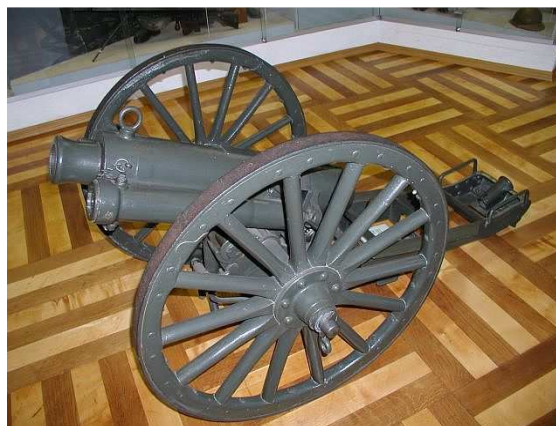
anglický 7,5 cm horský kanón vz. 01 soustavy Maxim-Nordenfeld, výroba zbrojovky Vickers, dostřel 4.412 m, hmotnost 380 kg, střely 8,2 kg, použit čs. legiemi v Rusku
