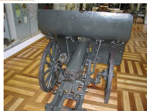
ruský 7,62 cm horský kanón vz. 1909, systém Schneider, vyroben v ruském putilovském závodě v r. 1916 (1917 ?) dostřel 7.000 m (6.400 ?) hmotnost 604 kg, střela 6,5 kg převoz soumary rozložený na 6 kusů ve výzbroji legií (1918 - 1920)
