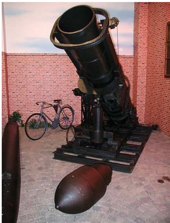
50 cm M vz. 1917, systém Storek vyrobila Storkova strojřna v Brně – jediný prototyp v r. 1917, hmotnost střely 200 kg
