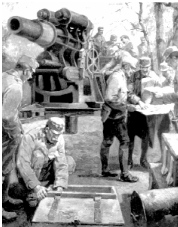
obsluha 30,5 cm moždíře v r. 1914 hmotnost střely 390 nebo 600 kg, dostřel 8 - 9,6 km střelba vrchní skupinou úhlů, granát na 8 km prorážel 1,5 m silný betonový kryt nebo 15 cm silnou pancéřovou kopuli délka hlavně 14,1 kalibrů
