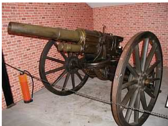
7,5 cm polní K d/26 z r. 1890 -zkušební soustava Škoda, dostřel 5.900 m, brzdovratné zařízení hmotnost 1.095 kg, střela 4,3 kg, poč.rychlost 425m/s, první polní dělo vyrobené ve Škodových závodech
