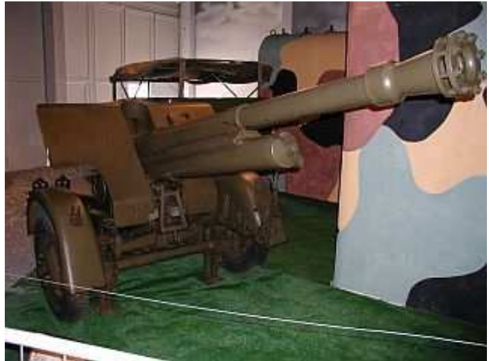
3,7 / 7 cm pěchotní K „BA1 / AB1“ dostřel 2.500 m / 6.900 m, střela 0,8 / 3 kg systém Škoda, zkoušen v letech 1930 -1931 výměna hlavně – vsunutím hlavně 3,7 cm, do výzbroje nebyl zaveden
