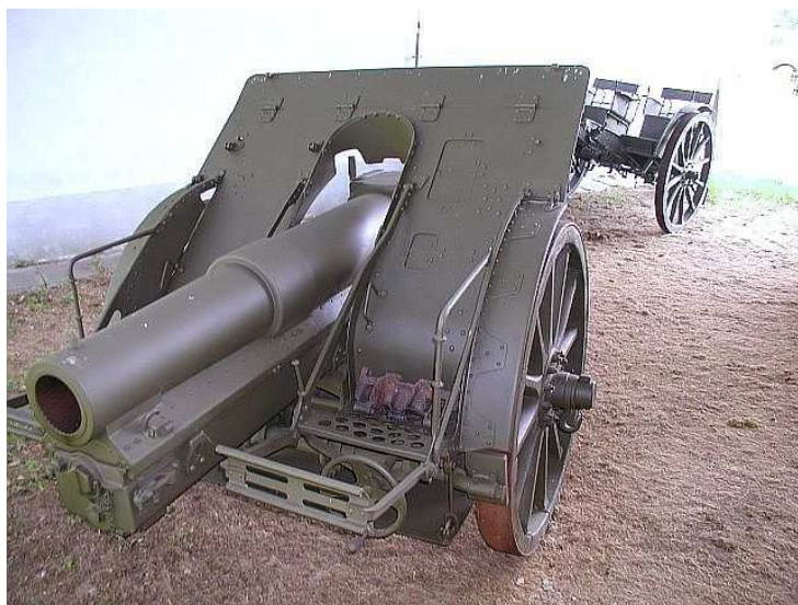
15 cm (149,1 mm) H vz. 14, systém Škoda , dělo s hlavnovým vozem
