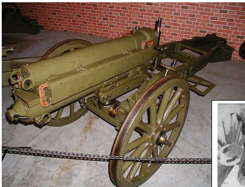
7,5 cm horský K vz. 07 se zvýšeným (či vysokým) výkonem soustava Škoda, dostřel 7.000 m (?), hmotnost 567 kg, střela 6,5 kg, poč.rychlost střely 380 m/sec, možnost změny palné výšky přetočením klikových náprav kol
