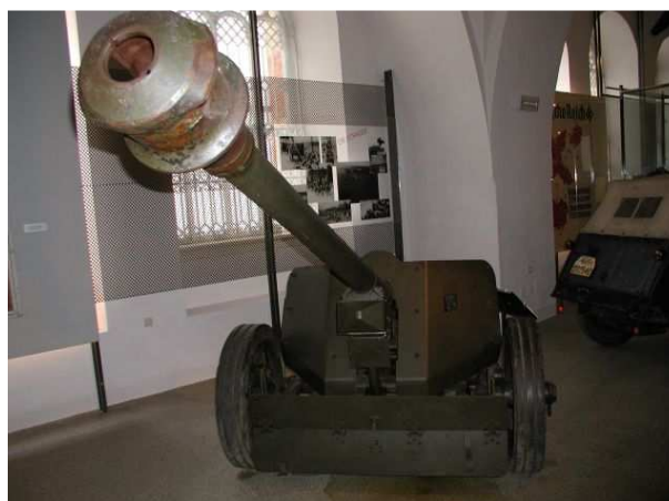
německý 7,5 cm PTK PAK vz. 1940 dostřel 10.000 m, hmotnost 1.425 kg rychlost střelby 12 - 14 výstřelů/min
