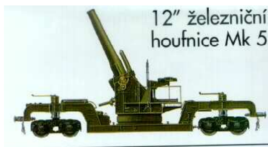
305 mm železniční houfnice Mk 5 dostřel 13.120 m, kruhový odměr, střela trhavá 340 kg, (v r. 1939 použity jako protiinvazní kanóny na východním pobřeží Anglie)
