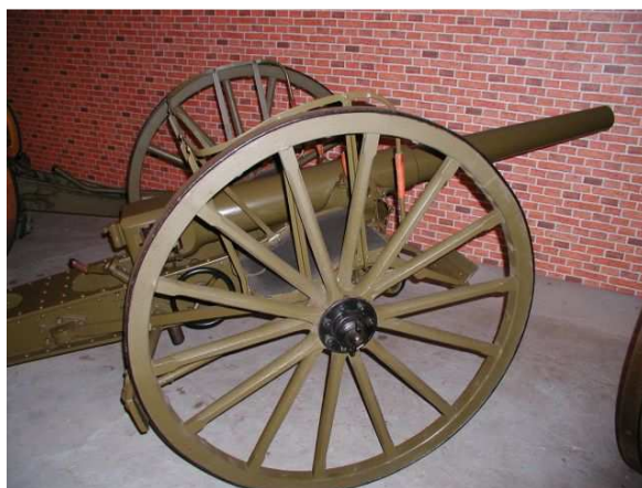
7,5 cm polní K z r. 1900 se záběhem lafety, soustava Škoda, pokusné dělo
