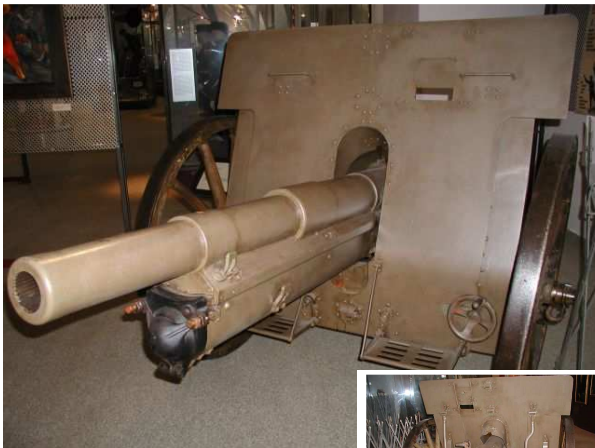
rakouský (?) 8 cm (76,5 mm) polní kanón M-18 na závěr 1. světové války - hlavní zbraň lehkého dělostřelectva hmotnost 1.330 kg, střely 8 kg
