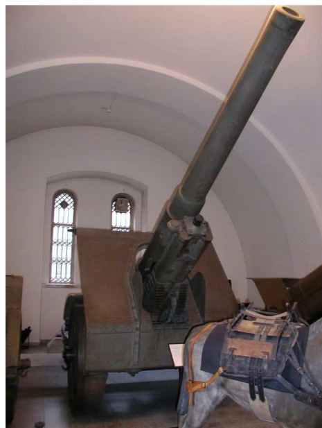
15 cm kanón vz. 1915 / 16, systém Škoda dostřel 20.700 m (?), hmotnost 13.300 kg střela 57,3 kg (?), poč. rychlost 700 m/s, 1 výstřel / min, obsluha 1+12
