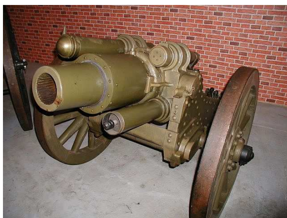
12 cm moždíř d/9,5 z r. 1899 soustava Škoda, dostřel 5.000 m, střela 20 kg, hmotnost 1.119 kg, poč.rychlost 300 m/s, možnost přímé střelby a použití v horách
