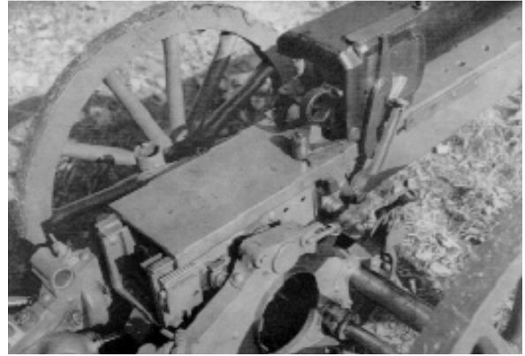
zkušební 7,5 cm horský K vz. 1910 s předkluzem hlavně soustava Škoda, dostřel 4.970 m, hmotnost 451 kg, střela 6,5 kg, poč.rychlost střely 340 m/s, pro řadu hrubých závad byly zkoušky zastaveny a tento způsob brždění zpětného rázu nepoužíván
