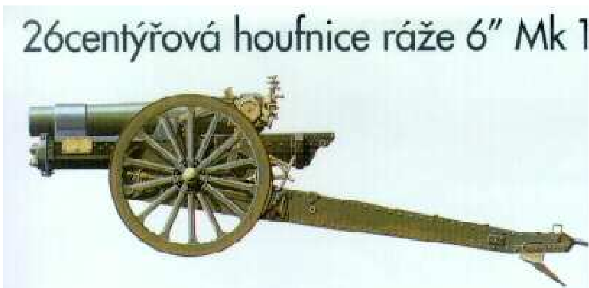
britská 152 mm (6“) H vz. 1915, standardní střední houfnice, do konce války vyrobeno víc než 3.600 ks, mnohé dodány i evropským armádám, po vybavení koly s pneumatikami sloužily i v 2. světové válce až do r. 1941, dostřel se 45 kg šrapnelem byl nedostatečný – s novou 39 kg tříštivotrhavou střelou dosáhl 10.425 m,
