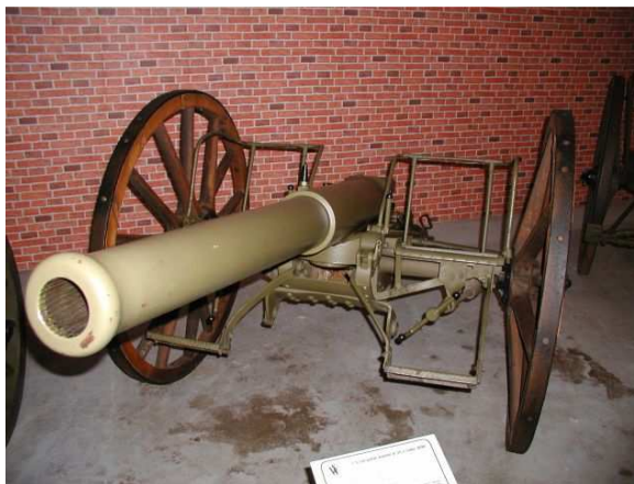
7,5 cm polní K d/35 z r. 1899 soustava Škoda, dostřel 5.000 m (?), se záběhem lafety, zkušební dělo
