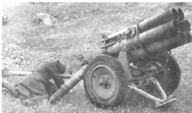
německý 15 cm raketomet WGr Nebel-Werfer 41 (existovalo i provedení - kola na lyžích) -- na bojišti hmotnost rakety 34,7 kg, dostřel 6.900 m, rychlost letu 340 m/s,
