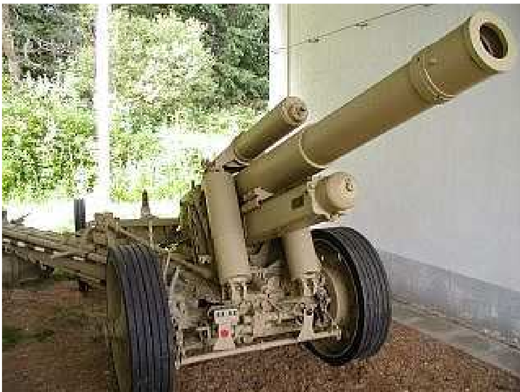
15 cm těžká polní houfnice sFH18 ze 30. let dostřel 13.325 m, hmotnost 5.512 kg, střela 43,5 kg, hlaveň Rheinmetall, lafeta Krupp (v ČSR modernizovaná na 152 mm H vz. 18/47 a používána do 70. let)
