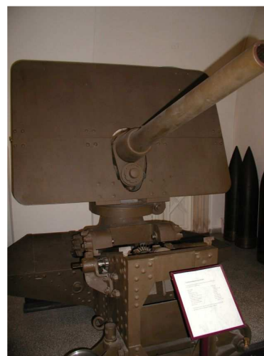
7 cm pobřežní kanón L/42vz. 1898 systém Škoda, obsluha 1+3 hmotnost 3.140 kg, střela 6,4 kg
