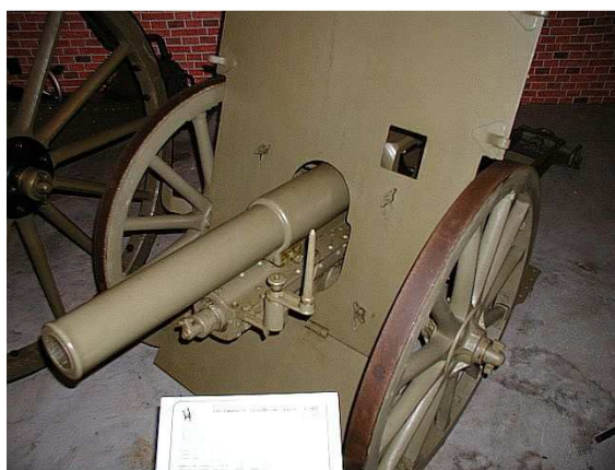
7 cm (6,55) námořní vylodňovací K d/18 vz.03 hmotnost 360 kg, střela 4 kg, poč.rych.329 m/sec soustava Škoda
