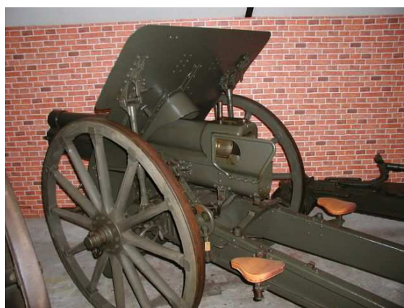
10,5cm polní H d/19 vz. 13 CH (Čína) soustava Škoda, dostřel 8.000 m, střela 14,1 kg, hmotnost děla 1.280 kg, poč. rychlost 340 m/s, pro export do Číny - v r. 1914 zabaveny voj. správou
