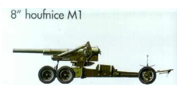
203 mm houfnice M1 dostřel 16.925 m, střela tříštvotrhavá 90,72 kg (po r. 1945 pro ni byla vyvinuta jaderná střela)
