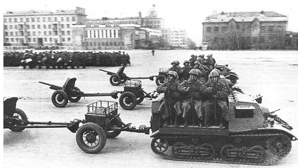
tahač „PIONÝR“ z r. 1935 se 76 mm K vz. 27 tahač „KOMSOMOLEC“ z r. 1936 se 45 mm PTK
