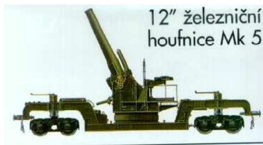
305 mm houfnice z. 1. světové války - tato pátá verze využita ve 2. světové válce pro obranu pobřeží, dostřel 13.120 m, střela trhavá 340 kg , kruhový odměr
