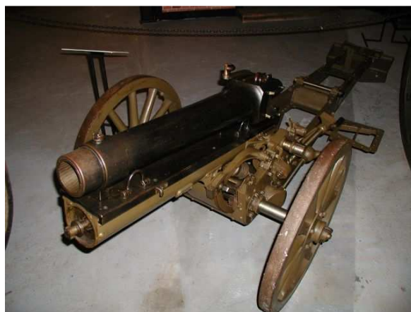
7,5 horský K d/13 z r. 1912 soustava Škoda, dostřel 4.200 m (6.700 m ?) střela 6,5 kg, poč.rychlost 320 m/sec
