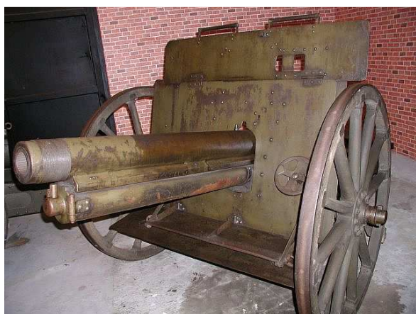
7,5 cm polní K d/29 z r. 1911 soustava Škoda, dostřel 6.000 m, střela 6 kg
