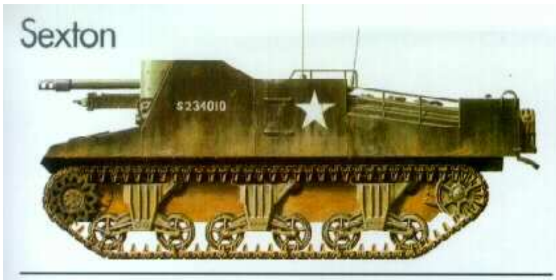
Sexton (kostelník) s 25 liberní 87,6 mm H pro palebnou podporu jednotek britských tankových divizí, zúčastnil se bojů v s. Evropě v letech 1944 - 1945 (vývoj od r. 1941, výroba pokračovala i po válce, celkem bylo vyrobeno 2.150 ks, používán v britské armádě i v 50.letech, použití v jiných armádách)
