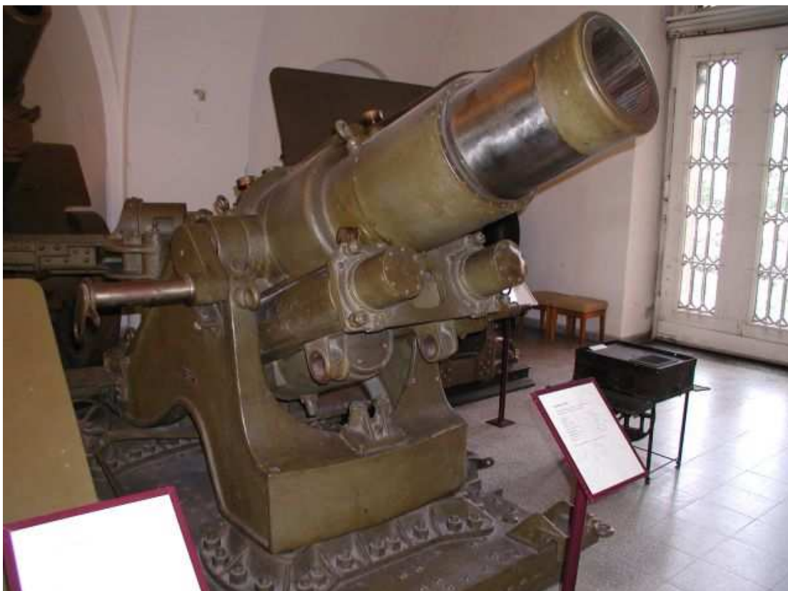
24 cm moždír vz. 1898, systém Škoda dostřel 6.500 m, hmotnost 9.300 kg, střela 133 kg, poč.rychlost 278 m/s, obsluha 1+5, (údaje z katalogu VHÚ: dostřel 7.000 m, hmotnost 7.010 kg, střela 128 kg, poč.rychlost 283 m/sec první těžké dělo vyrobené ve Škodových závodech, motorová trakce)
