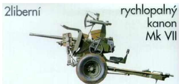
40 mm protitankový kanón z pol. 30. let účinný dostřel 1.000 m, průbojnost pancíře 42 mm (pod úhlem 60°), střela průbojná 9 kg, po zavedení v r. 1937 byl nejlepším PTK na světě, obsluhován dvěma dělostřelci – jako v jediné armádě
