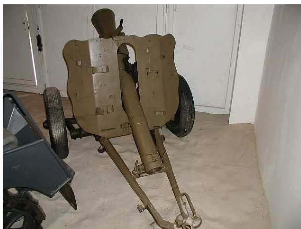
10,5 cm bezzákluzový kanón LG 42 Rheinmetall-Borsig dostřel 8.000 m, hmotnost 480 kg, střela 14,8 kg,
