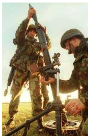
VB - 81mm M „M16-ML“(L16 A2) , dostřel 5 650 m, hmotnost 36,6 kg, mina 4,2 kg, 15 výstřelů / min.
