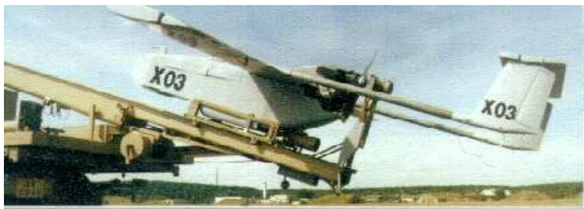
český bezpilotní letoun SOJKA III TV/TVM (komplet tvoří 4 letouny, startovací zařízení, řídicí stanoviště, rychlost letu 180 km/h, výška letu 200-2000 m, doba letu 90 min, akční rádius 40-60 km)
