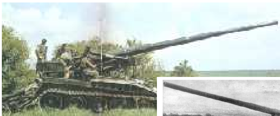
americký 175mm ShK M107 vývoj završen v březnu 1961, firmou Pacifik Car&Foundry Company , dostřel 32 700 m, hmotnost střely 148 liber, obsluha 13 mužů, do výzbroje asi v r. 1962, rychlost 56 km/h, dojezd 725 km, rychlost střelby 2 výstřely/min, nasazen ve Vietnamu (export v r. 1988 – Řecko, Irán, Izrael, Jižní Korea, Španělsko, Turecko, VB)
