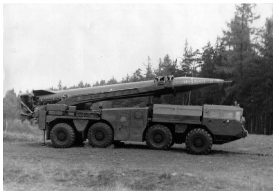
R-300 (Scud, SS-1C) 8K14 dolet kolem 300 km, v ČSLA od r. 1971 ( na pásovém podvozku SS-1B)
