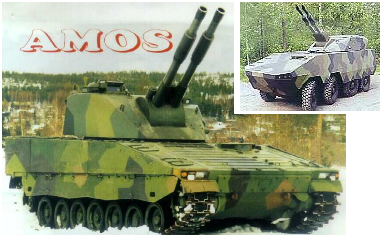
finsko-švédský 2x 120mm ShM AMOS B (Breech - nabíjení zezadu) 2S4 (Advanced Mortar System), ve švédsku označení SSG 120
