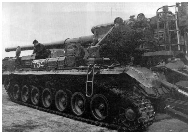
203 mm ShK vz. 75 2S7 „Pion“ dostřel 30.000 m, střela 140 kg, hmotnost 40 000 kg, 1 - 2 rány / min, palebný průměr 40 ks, obsluha 1+6
