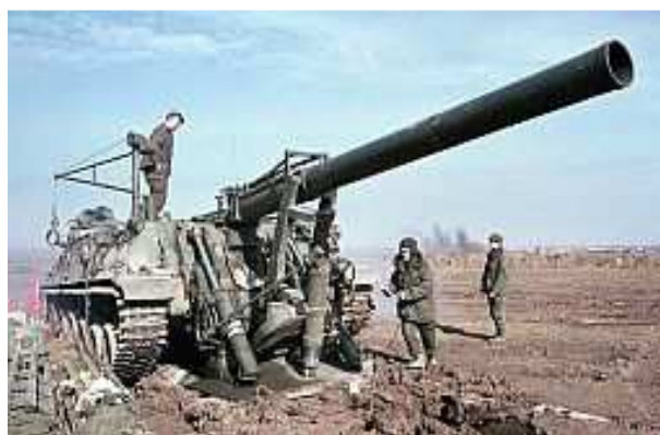
sovětský 240 mm ShM 2S4 „TULPAN“ (M 1975?) dostřel 9 650 m až 18 000 m (min. 800 m), obsluha 1+4, počáteční rychlost trhavé miny 310 m/s, hmotnost 27 500 kg, mina 135 kg, do bojové polohy za 3 min, jízdní dosah 500 km, rychlost 60 km/h, v terénu 30 km/h, veze 40 min, rychlost střelby 1 výstřel / min., příprava k boji 2,5 min., v sovětské armádě od r. 1975.
