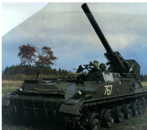
240mm ShM vz. 75 „Tulpan“ dostřel 9.650 m (18.000 m), střela 130 kg hmotnost 30 000 kg, 1 - 2 r / min, palebný průměr 40 ks, obsluha 1+4
