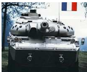
francouzský kolový obrněný transportér AMX 10RC se 105mm K v plně otočné věži
