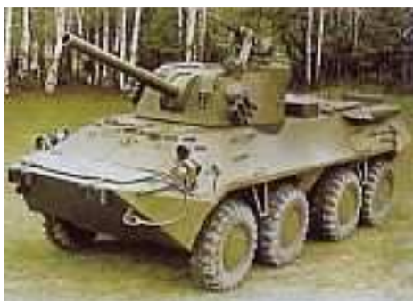
sovětský 120mm ShM 2S23 „NONA-SVK“ nejmodernější sovětský 120 mm ShM 2S31 „VENA“ dostřel 8 700/12 800 m, hmotnost 14 500 kg, dostřel 12 800 m, hmotnost 19 500 kg? 10 výstřelů / min., ve výzbroji od r.1987(1990?) možné použití jako klasický dělostřelecký systém BTR-80 veze 30 min, příprava k boji 1 min. 8 - 10 výstřelů / min., příprava k boji 1 min., z r. 1993
