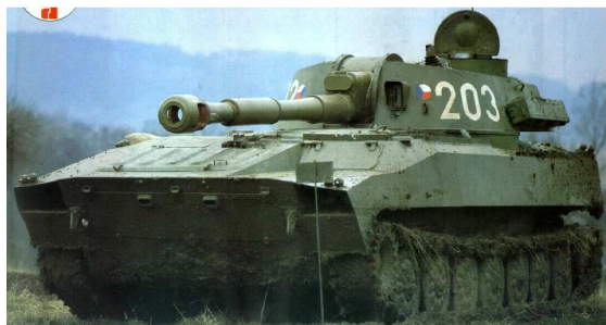
122mm ShH 2S1 „Gvozdika“ dostřel 15 200 m, 5 - 7 ran / min, střela 21,8 kg, palebný průměr 80 ks, obsluha 1+3, plovoucí
