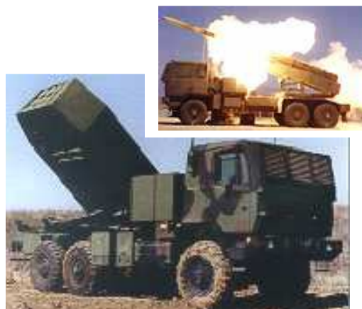
USA - 227mm RM „XM 142 HIMARS“ (High Mobility Artillery Rocket System) raketnice pro 6 raket M26, prototyp v r. 1998, zkušební nasazení v operaci Iraqi Freedom první jednotky mají být bojeschopné v r. 2006 možnost použití 1 rakety ATACMS na 300 km 3 osoby, předurčen pro pozemní síly (888 ks) a námořní pěchotu (40 ks), hmotnost 10 900 kg zamíření na cíl z pochodové polohy za 16 s
