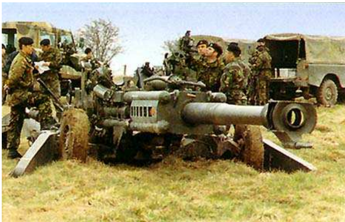
britská 155mm H M 777 A1, typ UFH, hlaveň dlouhá 39 ráží, v armádě od r. 1997
