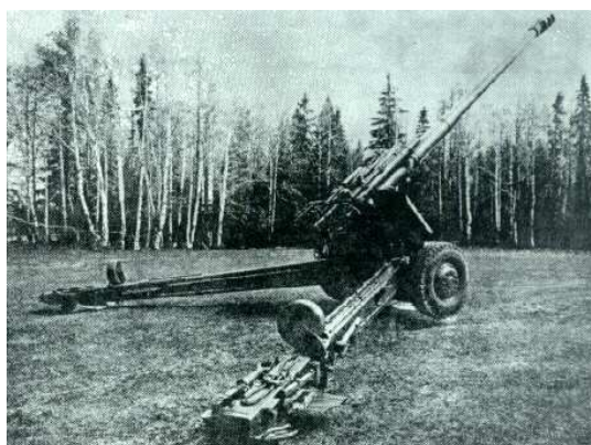
USA – modernizovaná 155mm H „M114 A2“ (instalace delší hlavně z děla M 198)
