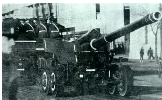
JAR - 105mm H firmy Denel, dostřel 32 000 m
