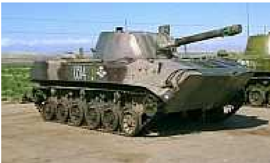
sovětský 120mm kanónový moždíř či minomet (ShM) 2S9 „NONA-S“ (ANONA?) hmotnost 8 700 kg., podvozek z OT (BTR-D), veze 60 min, spec. protipancéřová mina 13 kg probíjí pancíř 500 mm, dostřel až 12 800 m, 10 výstřelů / min., osádka 2 osoby, ve výzbroji Ruska a Ukrajiny od r. 1981 (1985?) - pro výsadkové vojsko, veze 25 min, příprava k boji 1 min
