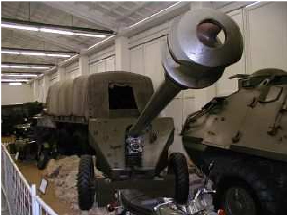
85 mm kanón vz. 52 „A22“ systém Škoda, dostřel 16 200 m, hmotnost 2 095 kg, střela 9,2 kg, použití nejen v ČSLA, ale i v dalších spřátelených armádách
