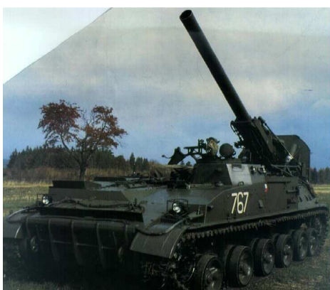
sovětský 240 mm ShM 2S4 „TULPAN“ (M 1975?) dostřel 9 650 m až 18 000 m (min. 800 m), obsluha 1+4, počáteční rychlost trhavé miny 310 m/s, hmotnost 27 500 kg, mina 135 kg, do bojové polohy za 3 min, jízdní dosah 500 km, rychlost 60 km/h, v terénu 30 km/h, veze 40 min, rychlost střelby 1 výstřel / min., příprava k boji 2,5 min., v sovětské armádě od r. 1975.
