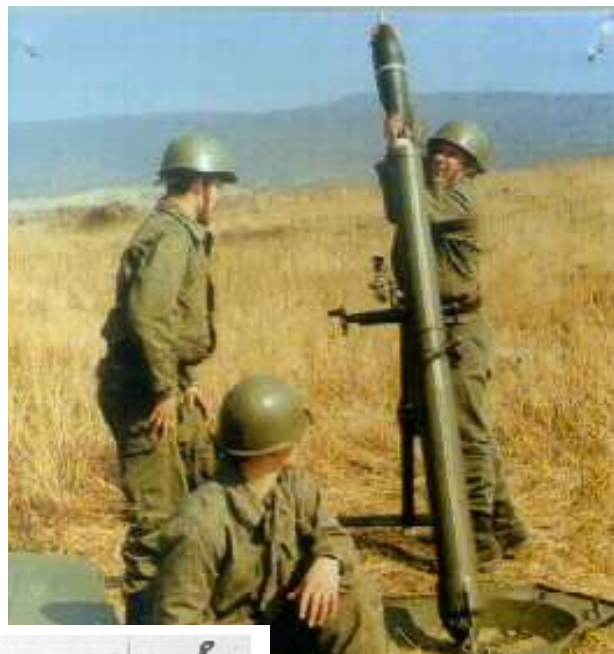
rakouský 81mm M M8-111 (211?) hmotnost 36,6 kg., dostřel 6 600 m, 30 výstřelů / min příprava ke střelbě 1 min, z r. 1990
