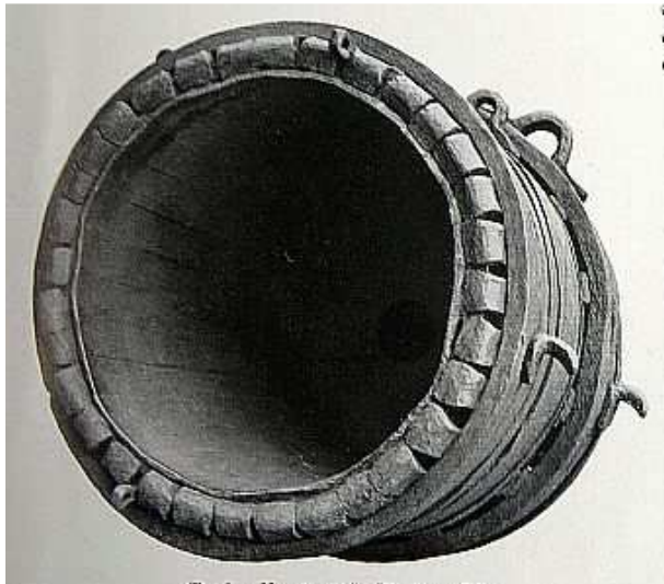
bombarda ze Štýru z 1/2 15. st. ráže 88 (80?) cm kamenná koule 725 (700?) kg dostřel až 900 m
