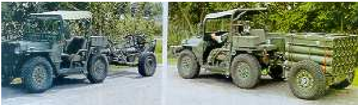
120 mm M RT 120 s tahačem + zásobovací muniční vozidlo s vlekem dostřel 7 200 m, výrobce GDOTS (General Dynamics Ordnance and Tactical Systems)
