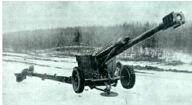
sovět. 120 mm M-H (minomet-houfnice) „NONA– K“ 2B16, dostřel 12 800, hmot. 1 200 kg, 8 - 10 výstř./min, příprava ke střelbě 2 min.
