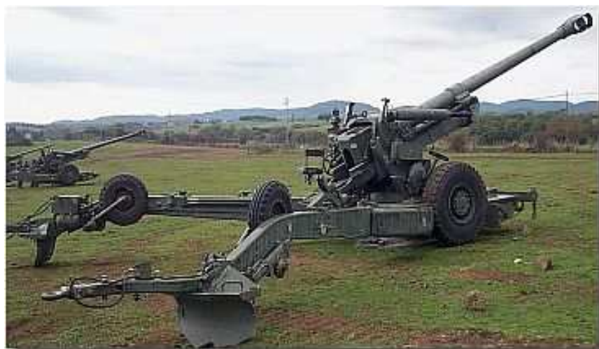
britsko-německo-italská 155mm H FH-70 (FH 155-1) Field Howitzer 1970 výroba firem Vickers, Rheinmetall, a OTO Melara, v licenci Japonsko, munice 155mm standardní NATO, dýmová a M712 Copperhead, hlaveň dlouhá 39 ráží, hmotnost 9 300 kg (8 800?) dostřel 24 000 m, se speciální municí 31 500 m, střelivo dělené - trhavé 43,5 kg, 6 výstřelů / min, dále 2 výstřely / min, počáteční rychlost střely 827 m/s, obsluha 7 osob, pomocný motor pro krátké přesuny, vývoj v 60. letech, prototyp v r. 1966, výroba od r. 1977, zavedení v letech 1978 - 1982, export od r. 1988
