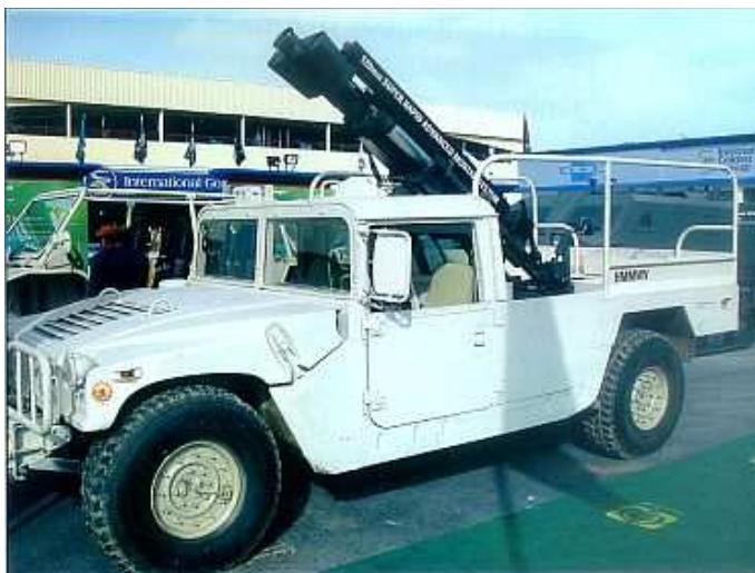
singapurský 120mm M 2R2M SRAMS (Super Rapid Advanced Mortar) na podvozku HMMWV, minomet se zpětným rázem, hmotnost 1 200 kg, 18 výstřelů / min, obsluha 3 osoby, dostřel 9 000 m, s municí s přídavným motorem až 13 000 m, lehký pohyblivý a výkonný komplet palebné podpory
