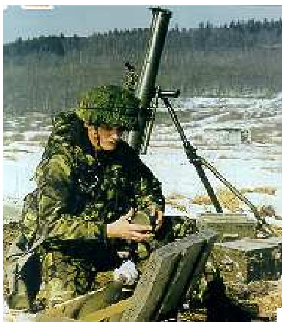
čs. 120 mm M (PRAM / L) vz. 82 dostřel 8 036 m (min. 250 m), obsluha 1+ 3, rychlost střelby 10 - 12 výstřelů / min, počáteční rychlost miny 352 m / s, bojová hmotnost 184 kg (245 kg s podvozkem), tříštvotrhavá mina 16 kg. Ve výzbroji AČR. Příprava k palbě 1 min, palebný průměr 80 min.
