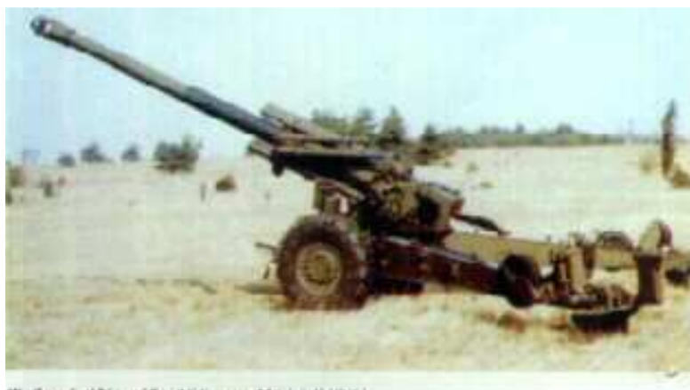
USA – modernizovaná 155mm H „M114 A2“ (instalace delší hlavně z děla M 198)
