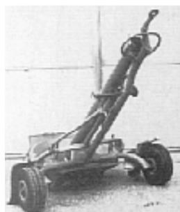
čs. 120 mm M (PRAM / L) vz. 82 dostřel 8 036 m (min. 250 m), obsluha 1+ 3, rychlost střelby 10 - 12 výstřelů / min, počáteční rychlost miny 352 m / s, bojová hmotnost 184 kg (245 kg s podvozkem), tříštvotrhavá mina 16 kg. Ve výzbroji AČR. Příprava k palbě 1 min, palebný průměr 80 min.
