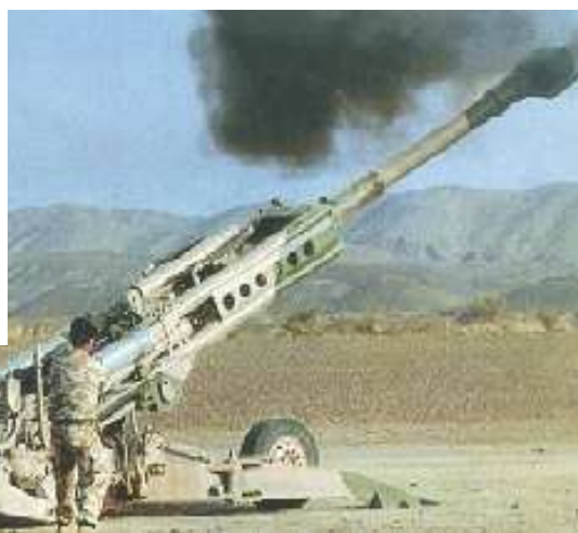
VB + USA - 155mm typ „UFH“ britské firmy Vickers a americké Textron hmotnost 3 750 kg, hlaveň dlouhá 39 ráží, dostřel 24 700 m, se speciální municí 30 000 m (prototyp XM 777)
