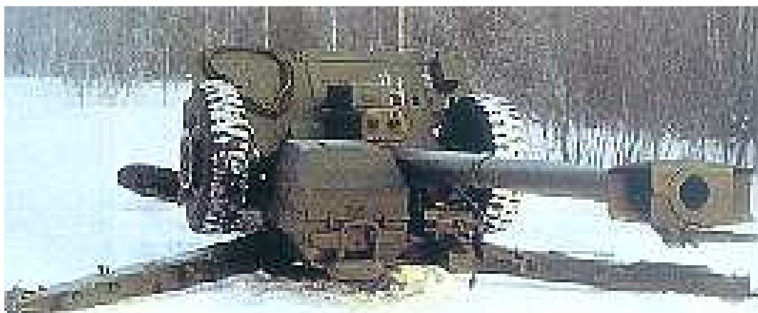
125mm PTK 2A45M (SPRUT-B) nejmodernější tažený PTK vyvinutý v SSSR, využití trojramenné lafety ze 122mm H D-30, hlaveň dlouhá 51 ráží, kruhový odměr, dostřel 12 200 m, přímá střelba 2 100 m, hmotnost 6 575 kg, 6 – 8 výstřelů / min, max. rychlost přesunu 80 km/h, dělená munice podkaliberní (20,7 kg, 1 700 m/s), kumulativní (29,6 kg, 905 m/s) a tříštivo-trhavá střela (32,5 kg, 850 m/s), možnost vystřelovat z hlaveň i PTRS typu 9K120 SVIR, pomocný motor pro přesun na krátké vzdálenosti rychlostí 14 km/h
