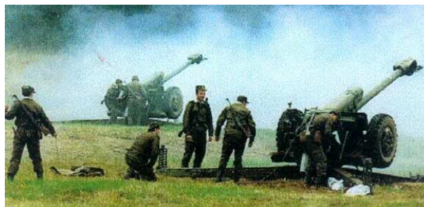
baterie 122mm H D-30 v palebném postavení dostřel 15 300 m, střela 29,3 kg, obsluha 1+6 palebný průměr 80 ks, poč. rychlost 690 m/s hmotnost 3 200 kg, rychlost střelby 6 - 8 výstřelů / min převedení do bojové polohy za 2,5 min
