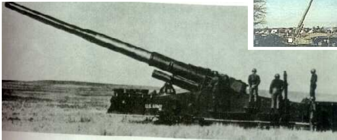
USA - 280mm K M65 - atomový kanón / „Atomic Annie“ – z r. 1952 kanón byl schopný odpalovat nukleární granáty vážící 272 kg na vzdálenost 29 km, důmyslná konstrukce – přepravován zavěšený mezi dvěma traktory – ale těžce se s ním manévrovalo, byl snadným terčem pro nepřátelské dělostřelectvo, poslední typ velkého děla, ve výzbroji amerických vojsk v Evropě i na Dálném východě. První střela s jadernou náplní byla vystřelena v nevadské poušti v r. 1953 (obr. z r. 1960)
