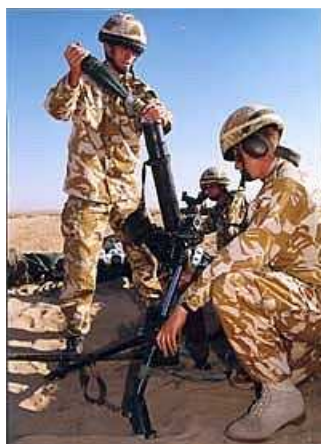
VB - 81mm M „M16-ML“(L16 A2) , dostřel 5 650 m, hmotnost 36,6 kg, mina 4,2 kg, 15 výstřelů / min.
