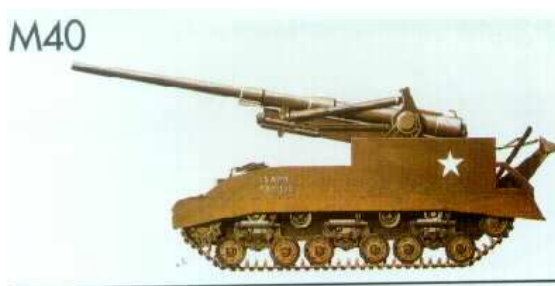
USA 155mm ShK M40 (s kanónem „Long Tom“) hmotnost 36,4 t , v Evropě se objevily při ukončení války – celkem vyrobeno 311 ks uplatnění v bojích v Koreji, kde se osvědčily, v Indočíně používány francouzskou armádou
